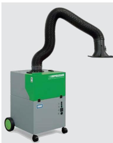
Equipo básico compacto para uso esporádico para la captación localizada y filtración de humos de soldadura y corte. La filtración de partículas se realiza por dos prefiltros y filtro principal mecánico, son desechables.
